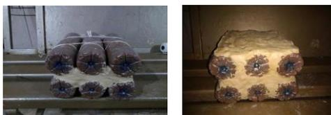
**Figura 1.** Garrafas sendo fixadas uma sobre as outras com o uso da argila escolar, primeiro protótipo. Fonte: Dos autores. 2019.
